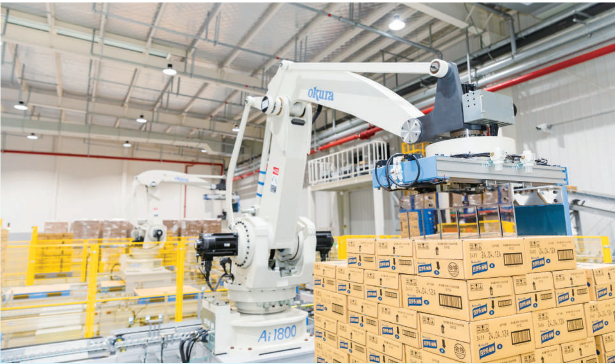
近日,在浙江好侍食品有限公司的包装车间内,一排排机械手精准地将产品进行码垛。该企业各产线实现高度自动化,每分钟能生产260余件各种风味的咖喱产品,整条包装产线机械化达到了90%左右,效率提升的同时也进一步确保了产品品质。
